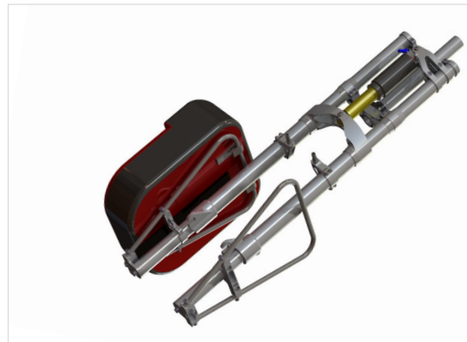
▲ Gitterrohrrahmen aus Carbon und Aluminium Muffen verklebt. Komplettes Chassis 2.1kg. Reichweite mit 1l Kraftstoff ca. 800km.
